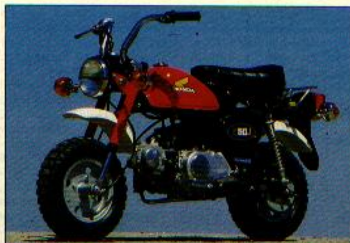
Die Basis: Im Serienzustand leistet die kleine Honda 1,8 PS bei 6000/min, die Crosser dagegen holen ganze 12 PS aus 75 cm 3
